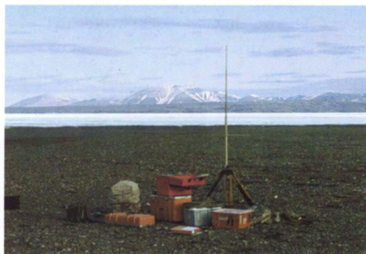
Dopplerstation, instrument, antenne og batteri
