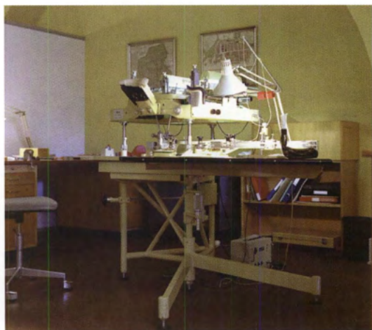
En udtegningsarbejdsplads som de fleste yngre topografer kender den. En stor del af Danmark D/10 er udtegnet på instrumenter af denne type – Kern PG2.
