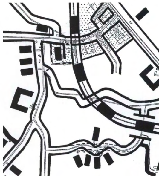
Grafisk generalisering på et 1 cm kort 1:100.00 sat op ca. 12 gange, så man kan se virkeligheden omsat til kort symbolik. Bemærk overdrivelserne
